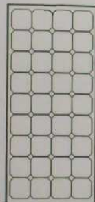
Slika 6.5: Sončne celice povezujemo v sončne module
